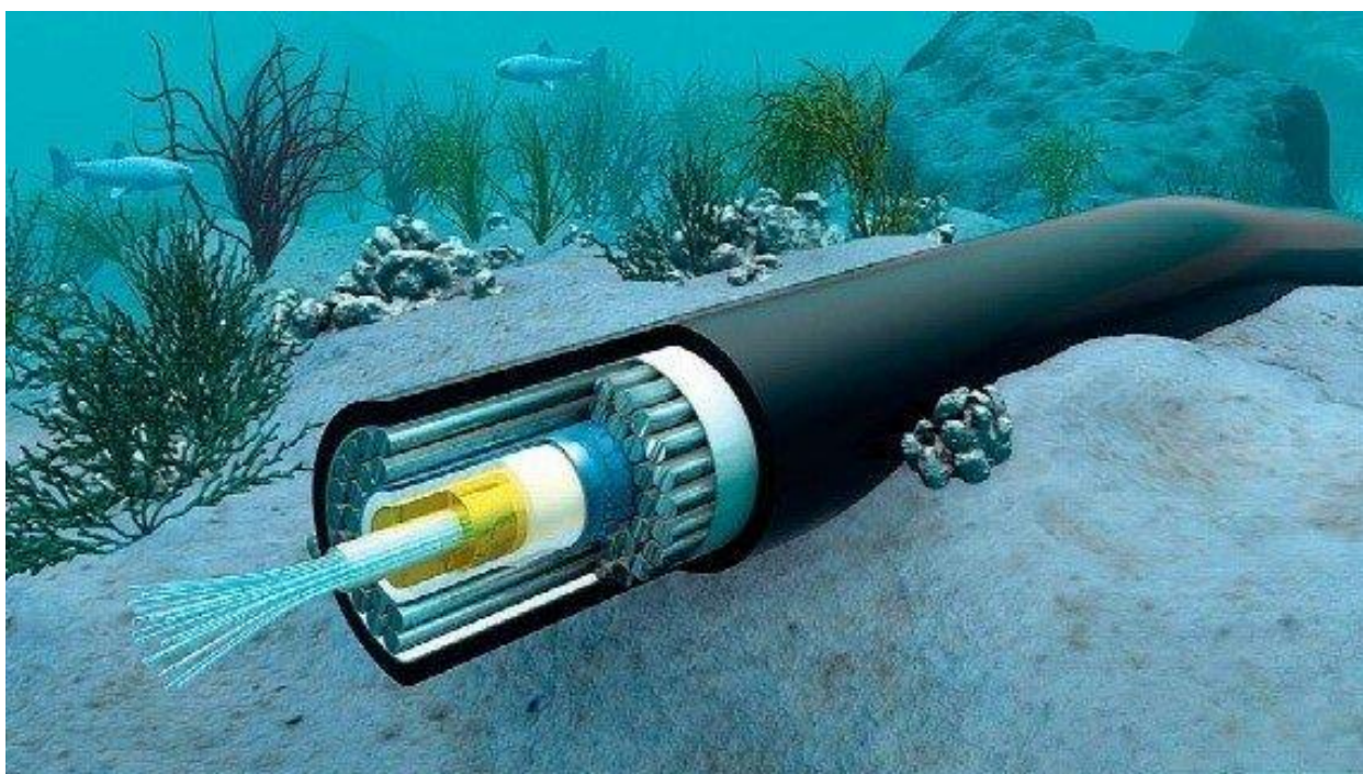
Figura 3. Ilustração de um cabo óptico subaquático – Fonte: Tecnoblog.
