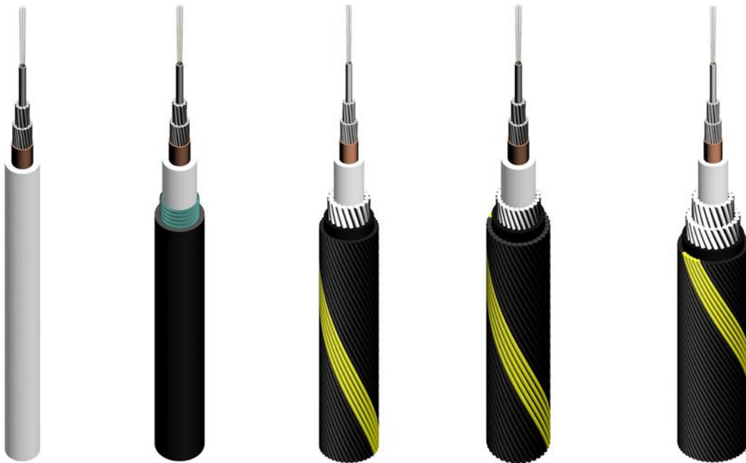
Figura 4 – Ilustrações dos tipos de cabos ópticos subaquáticos classificados na Recomendação ITU-T G.978.
