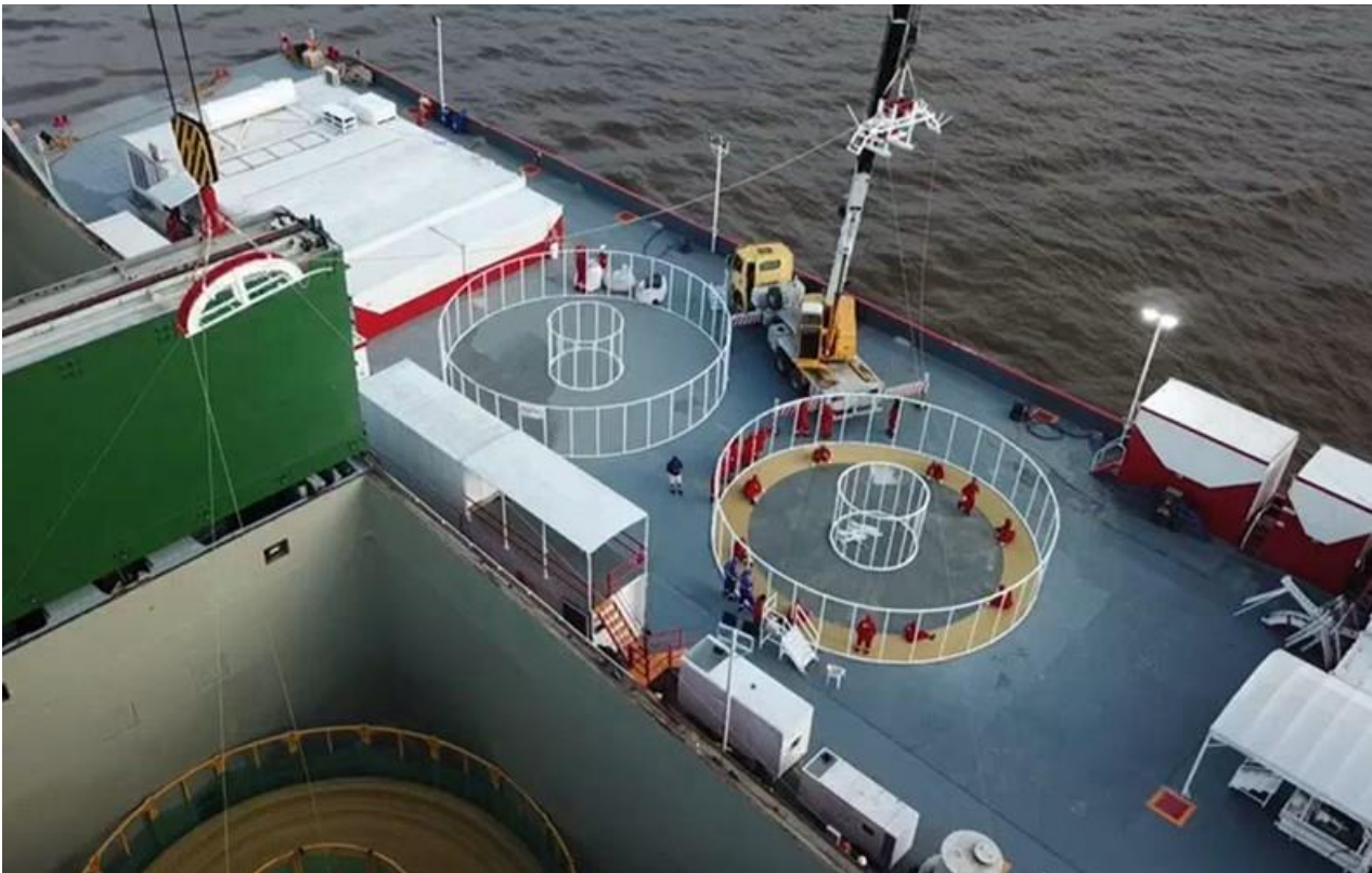
Figura 7. Processo de Transbordo do COS entre embarcação de transporte oceânico e Plataforma de Lançamento.
