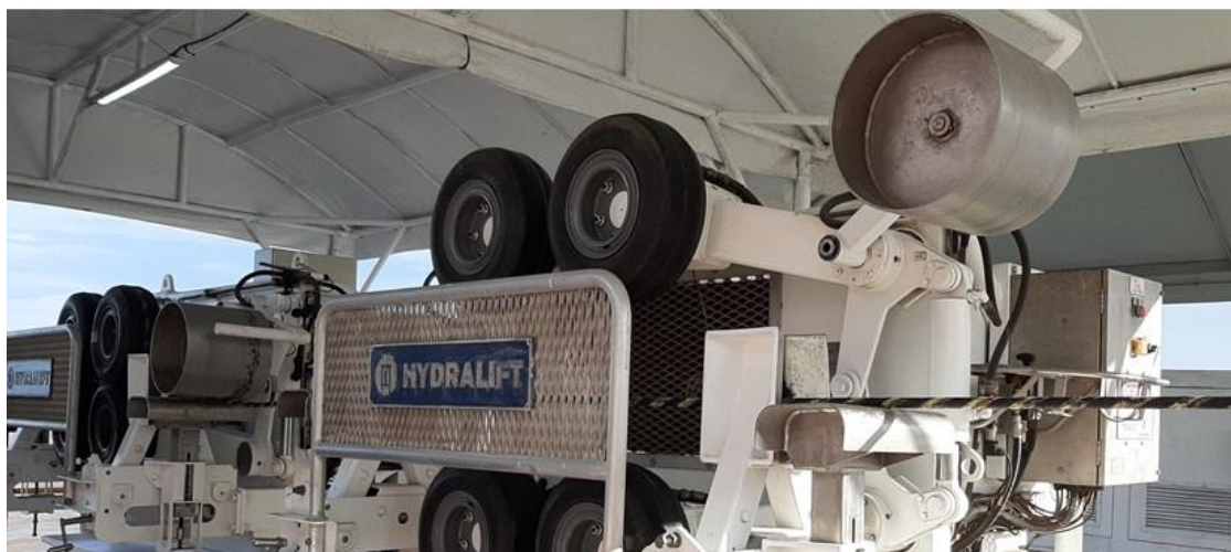
Figura 9. Motor de Carregamento Linear – LCE para lançamento do COS no rio.
