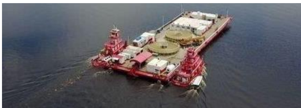
Figura 13. Embarcação de lançamento do cabo óptico subfluvial no rio Solimões (PAC-1) – Fonte: EB.
